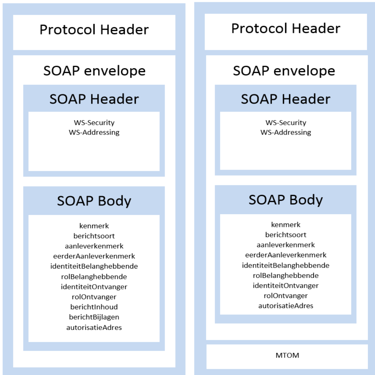
Figuur 2: SOAP Request voor de Aanleverservice (met en zonder gebruik van MTOM)
